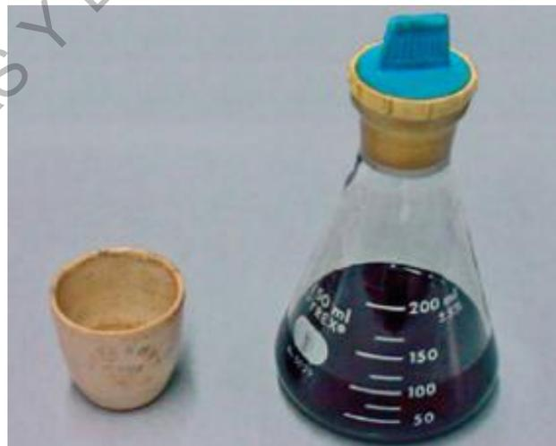
Figura 713 - 3. Muestra disuelta en tricloroetileno
